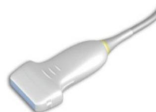
La **sonde convexe** présente une configuration sous forme de barrette courbée. Elle offre un balayage sectoriel et une forme d'image trapézoïdale. La largeur d'exploration est plutôt grande et elle est reconnue comme très efficace. Elle est très utilisée (abdomen, pelvien et obstétrique).
